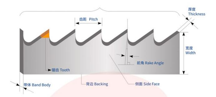
带体 带锯条上介于齿槽底部与背边之间的部分。 Band body:which simply means the backing.
